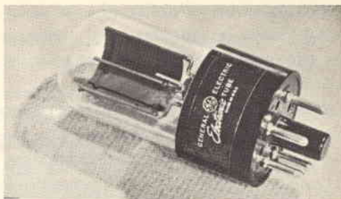
Un tipico fototubo costruito dalla General Electric.
