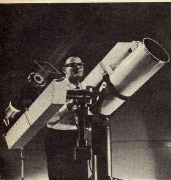
Il Colidar, prodotto dalla Hughes Aircraft Co., è un apparecchio adibito alla misura delle distanze e funziona sullo stesso principio del fucile che è illustrato nella fotografia di pagina 11.
